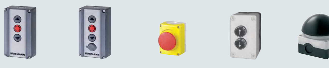
按钮开关 DTH R 独立的开/停/关按键 防护等级: IP 65 尺寸: 90 × 160 × 55 mm (W × H × D) 按钮开关 DTH RM 独立的开/停/关按键 带迷你锁：用于锁闭开关键功能，防止无关人员开启大门（配 2 把钥匙） 防护等级: IP 65 尺寸: 90 × 160 × 55 mm (W × H × D) 急停按键 DTNG 10 用于大门的急停操作 蘑菇式按键，按下即锁闭 外装式 尺寸: 93 × 93 × 95 mm (W × H × D) 防护等级: IP 65 2 键按钮开关 独立的开/关按键 防护等级: IP 44 尺寸: 70 × 118 × 65 mm (W × H × D) 蘑菇按键 塑料外壳、操作面积大 防护等级 IP 65 适用于 AK 500 FUE - 1 控制箱
