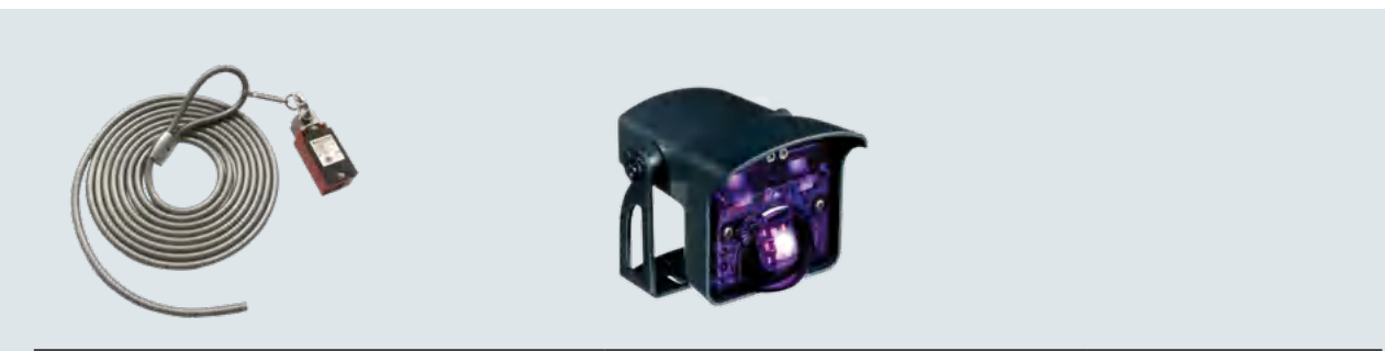
拉绳开关 可以水平或垂直安装，铸铝壳体，防护等级 IP 65，拉绳长度为 4 m 雷达/红外感应器 通过雷达感应物体的移动，通过红外感应物体的存在，从而快速准确的实现自动开门，可靠的保护功能，最大安装高度为 6 m。 在潮湿环境以及室外环境，仅雷达功能起作用。 壳体防护等级：IP 65
