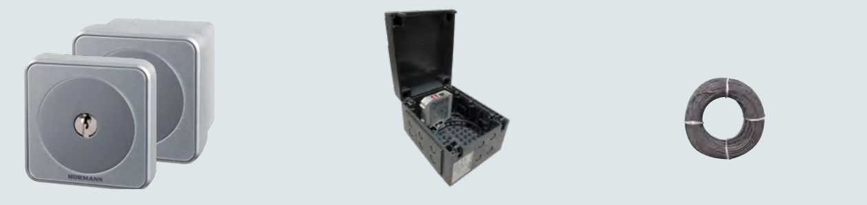
钥匙开关，标配 3 把钥匙 脉冲式 • 可回弹式钥匙开关，旋转钥匙即可触发开关门，常开触点一直保持闭合的状态 • 防护等级 IP 65 STUP50（嵌入式） 尺寸 (W x H x D) : 80 x 80 x 15 mm 嵌入连接盒: 直径 φ60 mm，深 55 mm STAP50（外装式） 尺寸 (W x H x D) : 80 x 80 x 65 mm 地磁感应器 双通道，可连接两组线圈 用于内外两侧 地磁感应器线圈铜线 50 m 每卷 电缆型号: SIAF 横截面积: 1.5 mm² 颜色: 棕
